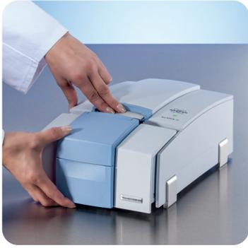
Les modules d'échantillonnage QuickSnap™ peuvent être facilement échangés sans aucun outil.
